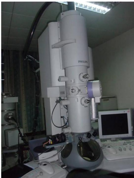
圖十七、穿透式電子顯微鏡一隅
