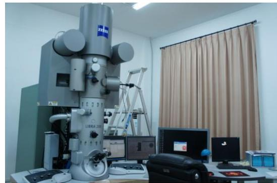
圖十六、穿透式電子顯微鏡外觀
